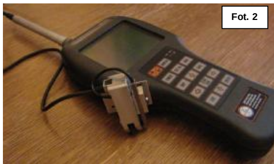
Fot. 2. Miernik koncentracji naprężeń typ IKN-2M-8
